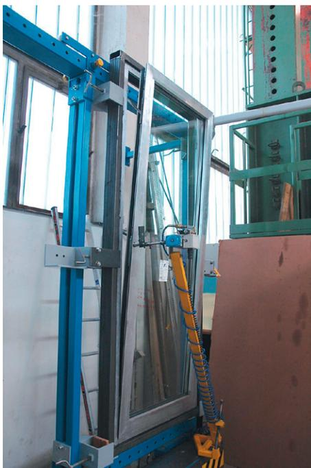
Abb. 3: Einflügelige Balkontür im Dauerfunktionsstand
