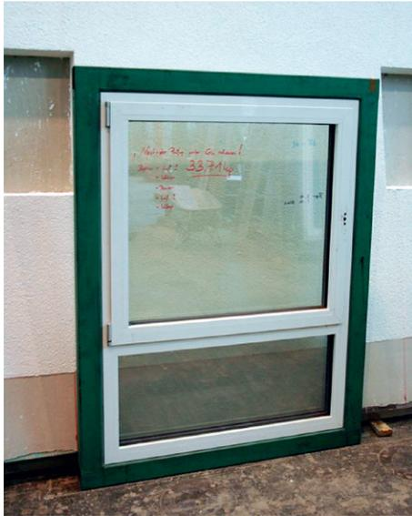
Abb. 2: Voll funktionsfähiges, einflügeliges Drehkipp-Fenster nach den Prüfungen
