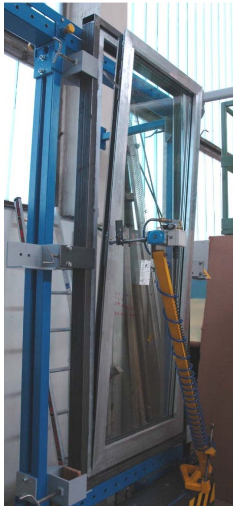
Abb. 8: Fenster 3 im Dauerfunktionsprüfstand
